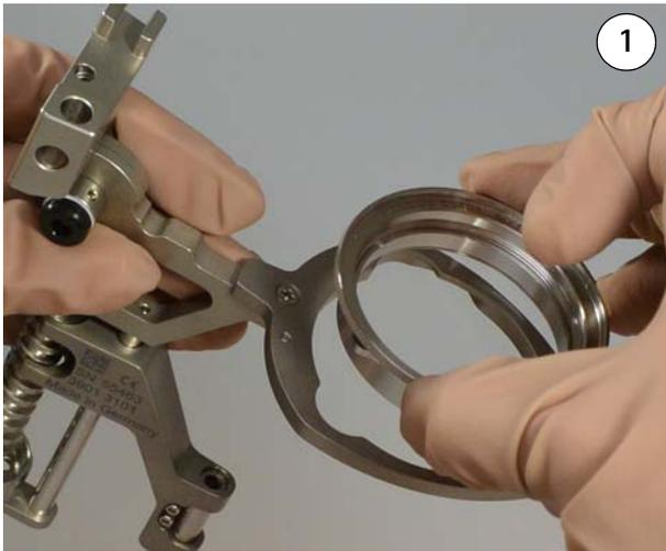
→ Monte la lente reductora. A continuación gire la lente reductora hacia la derecha hasta el tope.
