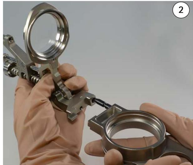
→ Inserte la placa adaptadora hasta el tope.
